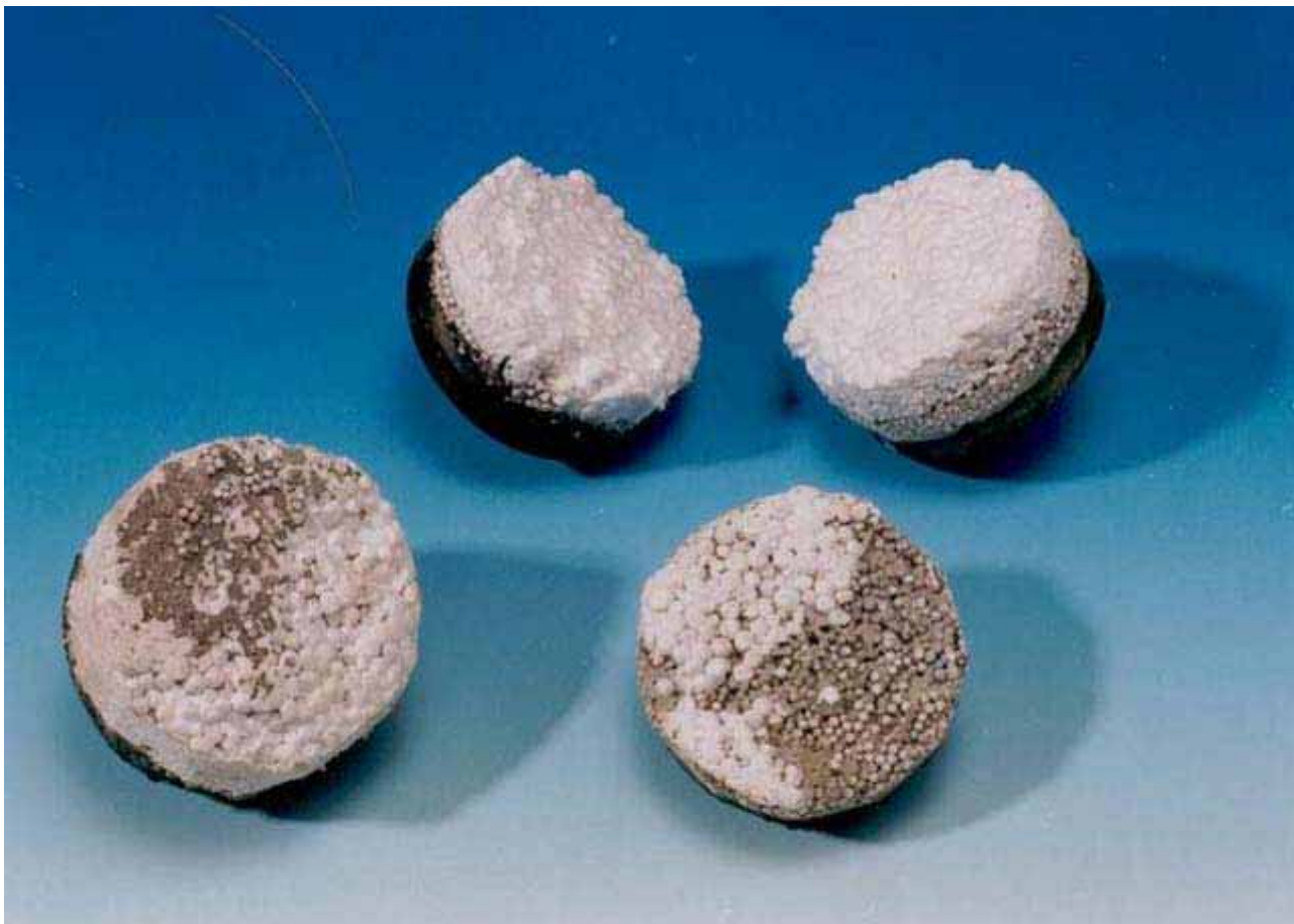
Внешний вид образца после проведенного испытания адгезии полистиролбетон – полистирол – полистиролбетон - ТРЕХСЛОЙНЫЕ СИМПРОЛИТ ИЗОЛЯЦИОННЫЕ ПАНЕЛИ -
